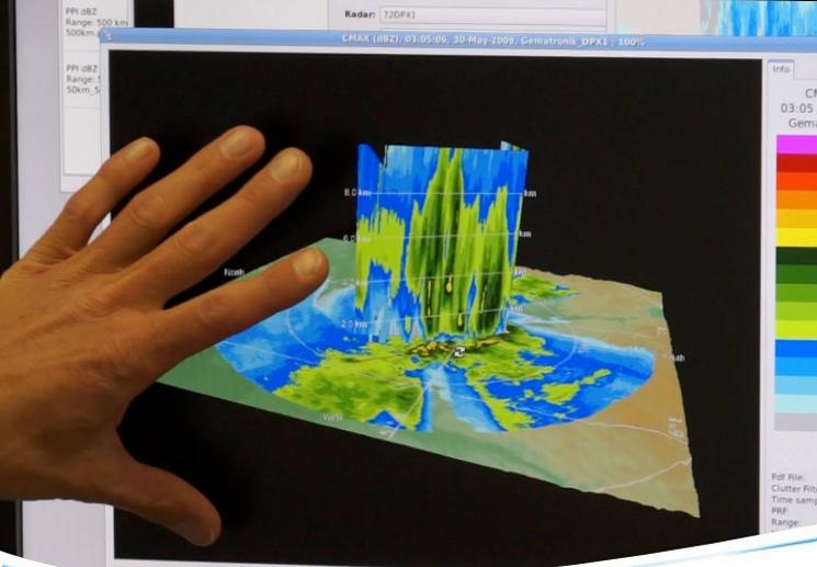
Image 3D de données à haute résolution du radar en bande X et à double polarisation Meteor 60DX (SELEX)
